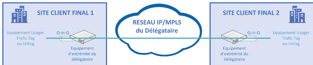
Les trames Ethernet de l'Usager sont transportées entre les deux sites Clients Finals au travers du réseau IP/MPLS du Délégué, suivant le débit et les SLA souscrits pour le Service.
