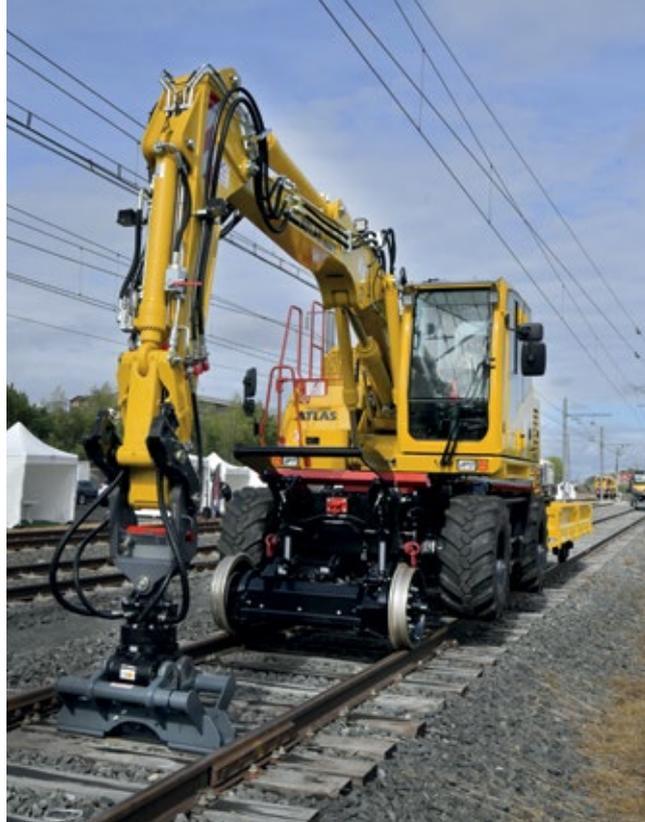
Des engins capables de circuler sur route et sur rail.
